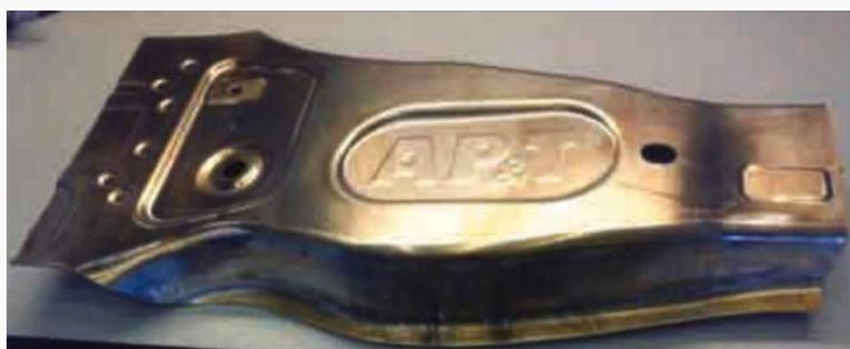
Figura 2: Peça protótipo fabricada com liga de alumínio de alta resistência que está sendo desenvolvida pela Novelis
